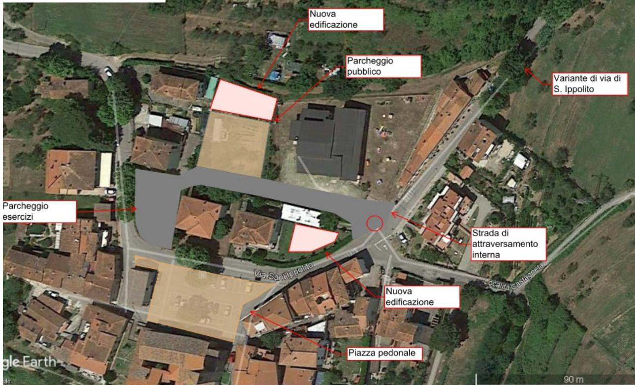
Con questa seconda soluzione si creerebbe una isola centrale edificata, intorno alla quale passerebbero - a senso unico - a nord il traffico in ingresso (con una nuova viabilità di attraversamento posta a valle della scuola) e quello di uscita (antistante la piazza della Pieve). Sia a nord che ad Ovest sono previsti parcheggi di servizio per la scuola ed i residenti e per gli esercizi commerciali.
