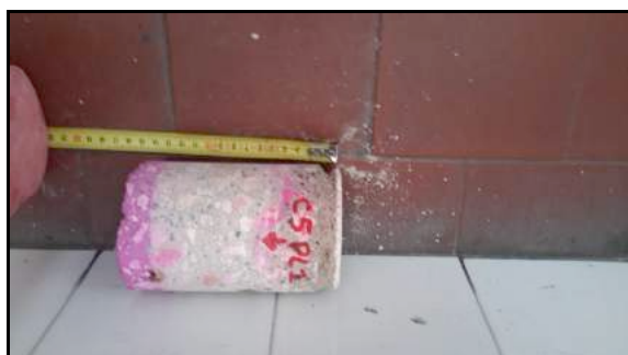
Figg. 19-20 Campioni C5 e C6 sottoposti a prova di carbonatazione
