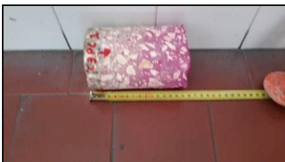
Figg. 17-18 Campioni C3 e C4 sottoposti a prova di carbonatazione
