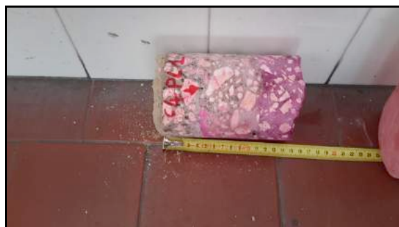
Figg. 17-18 Campioni C3 e C4 sottoposti a prova di carbonatazione
