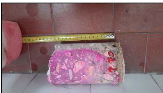
Figg. 15-16 Campioni C1 e C2 sottoposti a prova di carbonatazione
