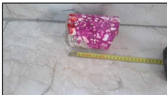
Figg. 15-16 Campioni C1 e C2 sottoposti a prova di carbonatazione
