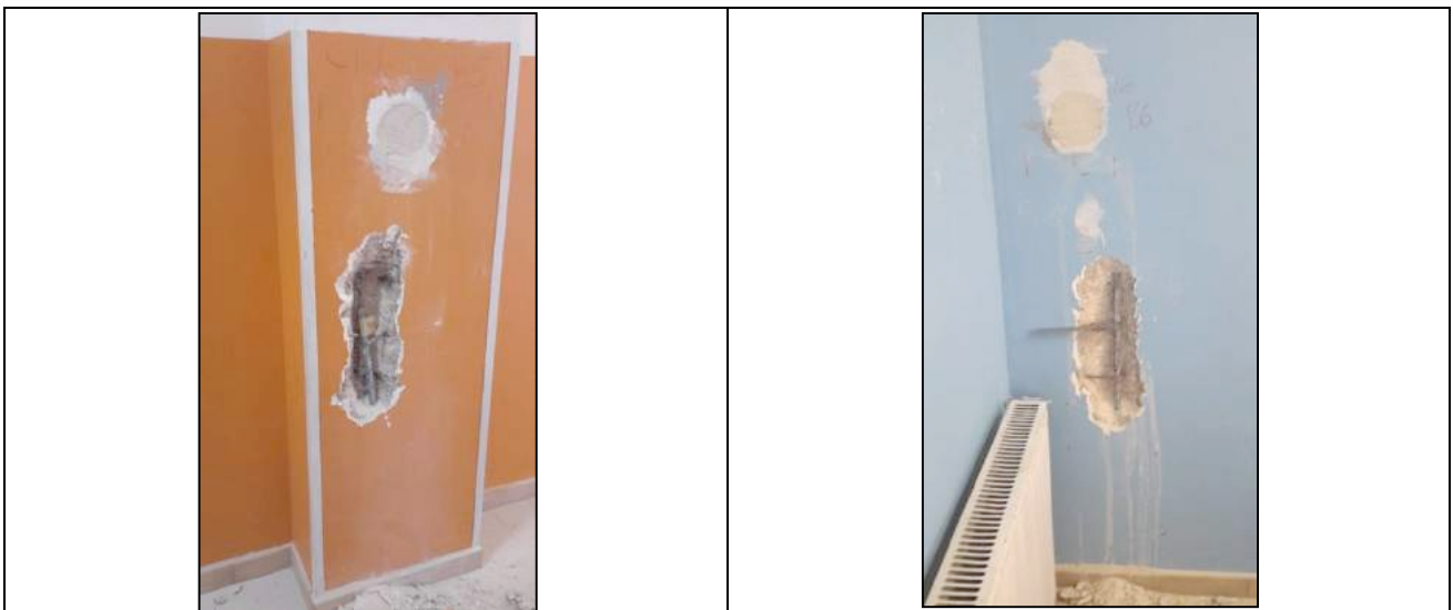
Figg. 79-80 Prelievo campioni armatura metallica B 5 e B 6
