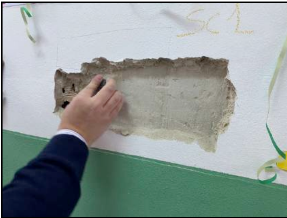
Figg. 21-22 preparazione della superficie e Prova sclerometrica SC 1
