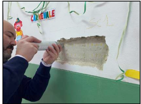
Figg. 21-22 preparazione della superficie e Prova sclerometrica SC 1
