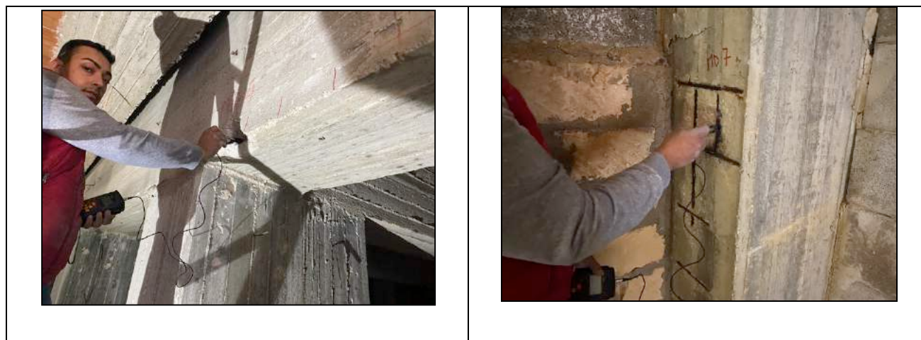
Figg. 83-84 Prove microdurezza su una trave e su un pilastro del corpo 5 a quota -650
