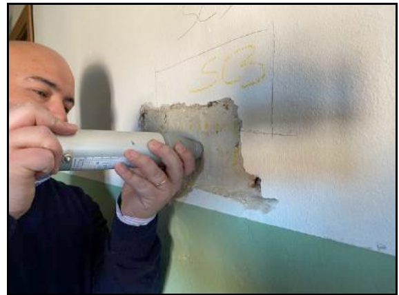
Figg. 23-24 Prova sclerometrica SC 2 e SC 3
