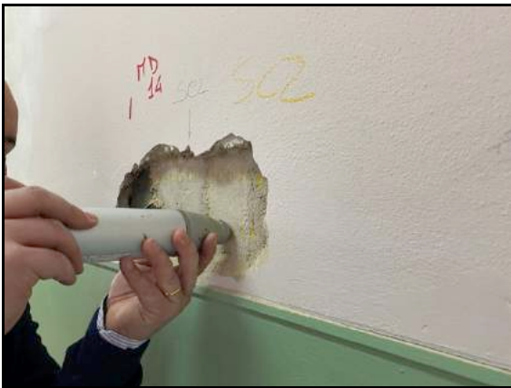
Figg. 21-22 preparazione della superficie e Prova sclerometrica SC 1
