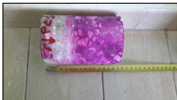
Figg. 19-20 Campioni C5 e C6 sottoposti a prova di carbonatazione
