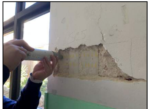
Figg. 25-26 Prova sclerometrica SC 4 e SC 5
