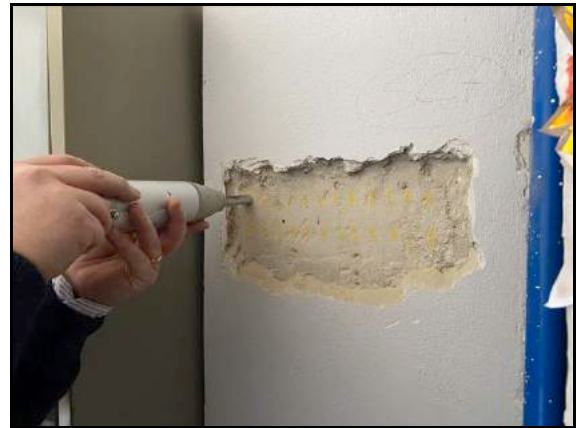
Figg. 27-28 Prova sclerometrica SC_6 e SC_7
