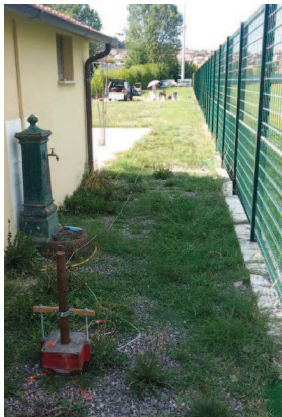
Figura 3 – Sistema di generazione delle onde di superficie
