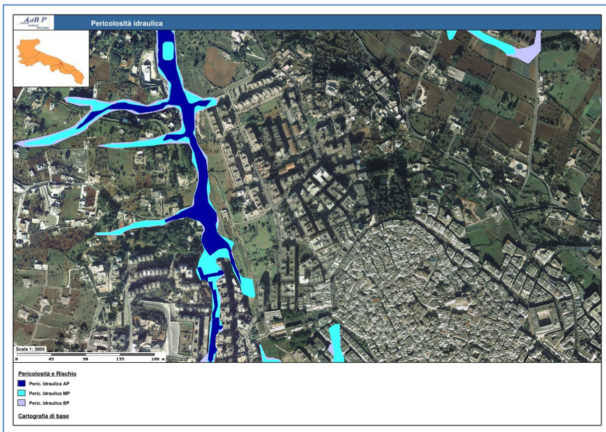
Figura 8 – Pericolosità idraulica (PAI AdB Puglia).
