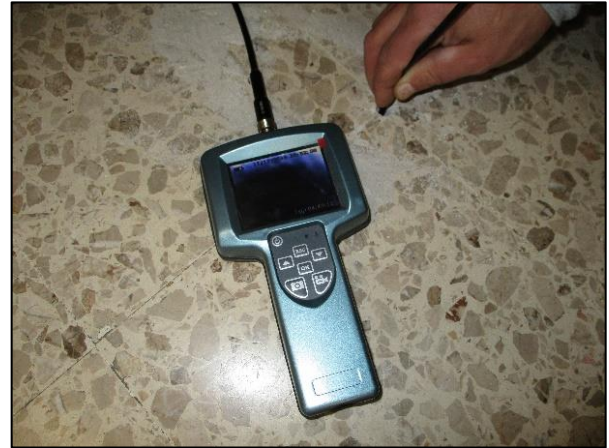
Foto 8 – Analisi endoscopica condotta all'estradosso del solaio.
