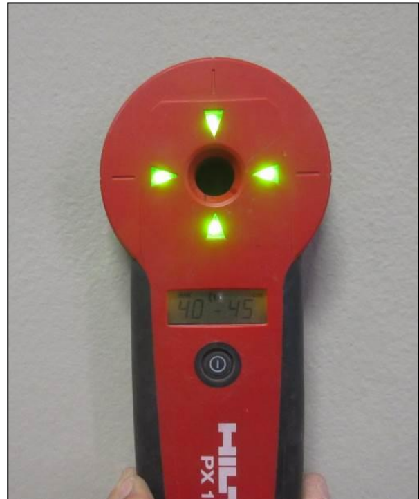
Foto 6 – Misurazione indiretta dello spessore di un setto murario.
