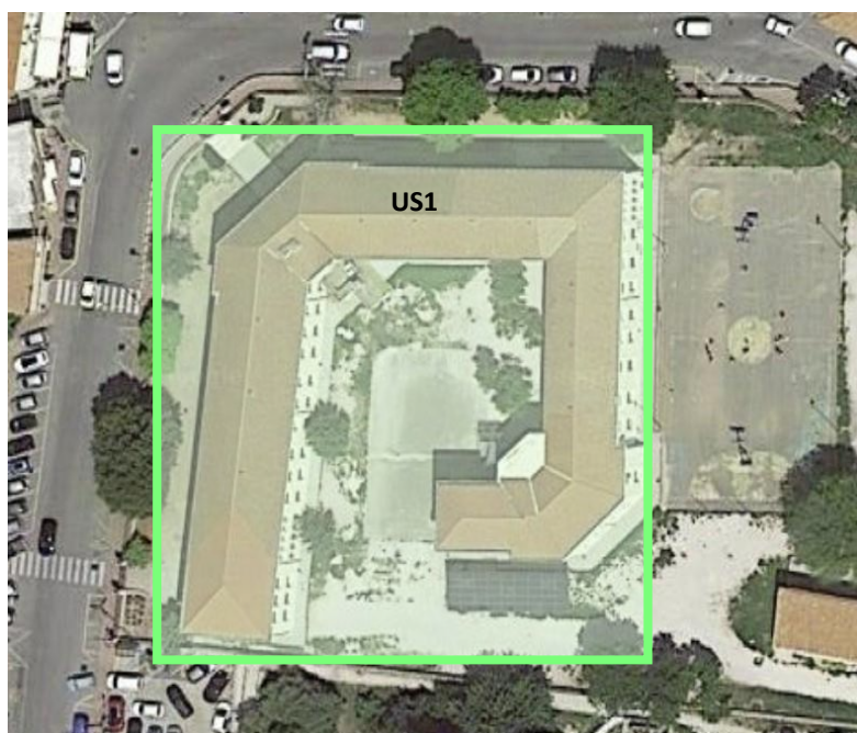
Foto 2 - Suddivisione dell'edificio in Unità Strutturali (US1 in verde chiaro).
