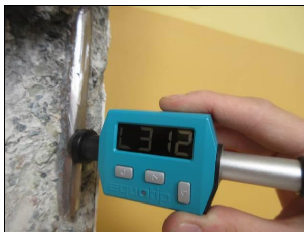
Foto 3 – Prova durometrica su barra di armatura.
