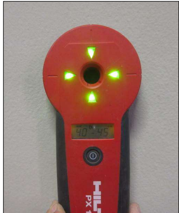
Foto 1 - Misurazione indiretta dello spessore di un setto murario.
