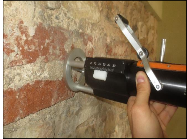
Foto 5 – Esecuzione della prova penetrometrica su malta.
