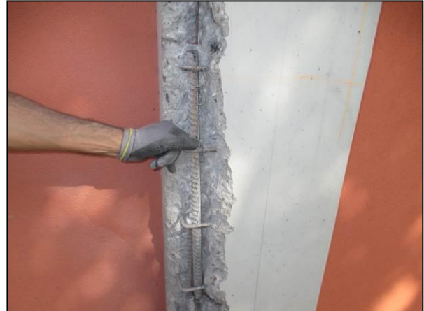
Foto 2 – Prelievo barra di armatura.
