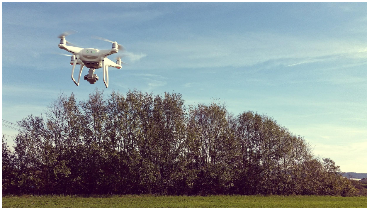
Aeromobile a pilotaggio remoto impiegato per le attività di sorvolo e presa fotogrammetrica
