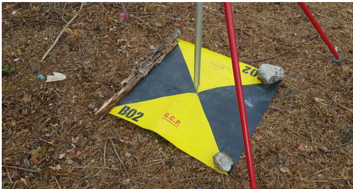
Target di appoggio per il rilievo aerofotogrammetrico materializzato a terra mediante foglio in PVC
